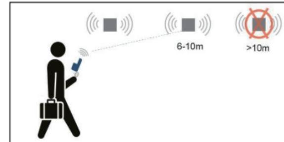
Die Reichweite, über die ein Smartphone mit dem Produkt kommunizieren kann, hängt von der Bluetooth-Fähigkeit des Smartphones ab. Auch die Position des Produkts und die Umgebung zwischen dem Smartphone und dem Produkt können die Kommunikation beeinflussen.
