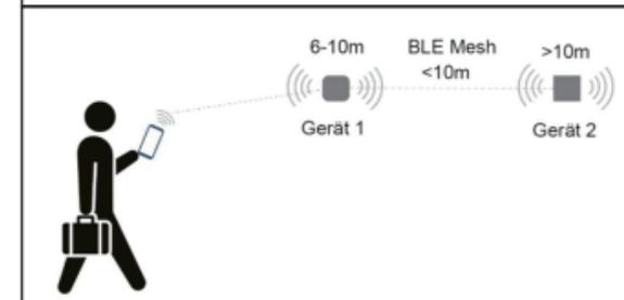
Mit BLE Mesh kann die Entfernung zwischen dem Smartphone und dem Produkt mehr als 10 m betragen.
